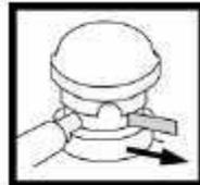
Entfernen Sie vor dem ersten Gebrauch die unter dem Pumpkopf befindliche Sicherheitssperre (Plastiklasche).
