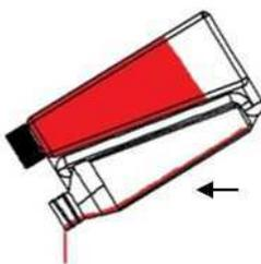
Eine kleine Flüssigkeitsmenge bleibt in den Wänden der Kammer zurück. Die Kalibrierung der Kammer berücksichtigt dies. Das Drücken der Flasche während des Ausgießens der Lösung aus der Dosierkammer vermeiden.
