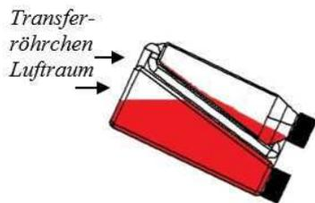
Die Flasche so schwenken, dass innerhalb der Flasche am Beginn des Transferröhrchens ein Luftraum entsteht.
