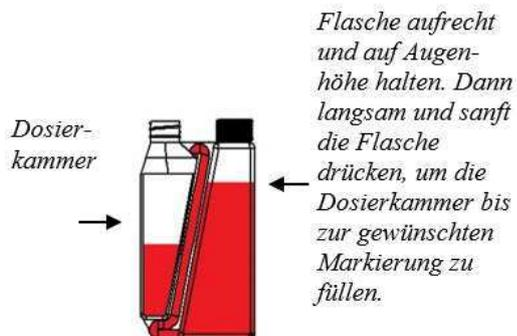
Bei Überfüllung der Dosierkammer Anweisung zur Behebung von Überfüllung befolgen.
