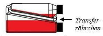
Die Flasche horizontal halten, damit die Flüssigkeit das Ende des Transferröhrchens innerhalb der Dosierkammer bedeckt.
