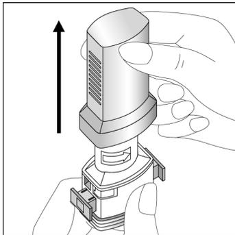
2. Öffnen der Kapselkammer. Halten Sie den unteren Teil des Aerolizers fest und drehen Sie das Mundstück in Pfeilrichtung.
