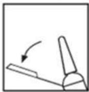
Entfernen Sie die graue Nadelschutzkappe, indem Sie sie gerade abziehen (siehe Abbildung 2).
