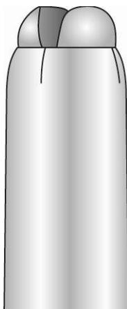
Die Knöpfchen am Ende der lateralen Arme müssen sich knapp über dem Ende der Einführhülse eng gegenüberliegen (Vergrößerung 1).
