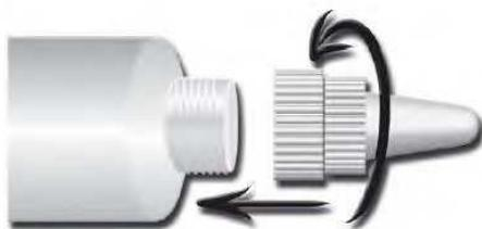
3. Verschlusskappe durch Drehen gegen den Uhrzeigersinn entfernen.
