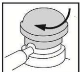
Drehen Sie den oben auf dem Dosenkörper befindlichen Pumpkopf, bis die darunter liegende halbkreisförmige Einkerbung in Richtung des Applikators weist. Die Sprühdose ist nun gebrauchsfertig.
