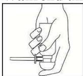
Legen Sie Ihren Zeigefinger auf die Spitze des Pumpkopfes und drehen Sie die Sprühdose auf den Kopf. Beachten Sie, dass die Sprühdose nur dann einwandfrei funktionieren kann, wenn der Pumpkopf nach unten weist.
