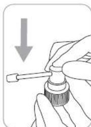
1. Applikator auf die Pumpe aufsetzen. Dazu Pumpe unten gut festhalten und gleichzeitig oben auf den Applikator drücken.
