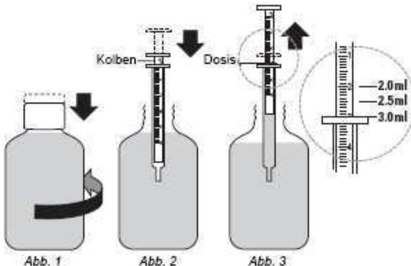
2. Stellen Sie sicher, dass der Kolben der Applikationsspritze vollständig nach unten gedrückt ist, und tauchen Sie diese dann in die Lösung (Abbildung 2).
