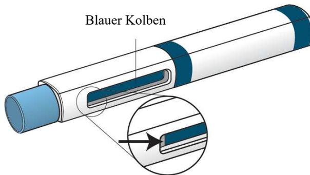
Der blaue Kolben schiebt sich bei der Injektion immer weiter in das Sichtfenster; wenn er das Sichtfenster ausfüllt, ist die Injektion abgeschlossen.
