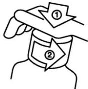
Die Flasche ist mit einem kindergesicherten Verschluss versehen. Er wird geöffnet, indem der Schraubverschluss nach unten gedrückt und dabei gegen den Uhrzeigersinn gedreht wird.
