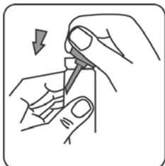
5. Sicherheitsring entfernen. Sicherheitsring nicht wegwerfen, da dieser beim Transport der Flasche wieder angebracht werden sollte, um die Pumpe zu verriegeln.
