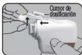
Montaje – Inserción del cursor de dosificación
