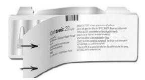
2. Ensamblar ambas partes enroscando la boquilla en la rosca del tubo, y girar en sentido de las agujas del reloj para perforar la membrana de aluminio sellada.
