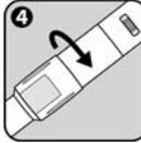
4. Rode completamente a proteção da janela da solução no sentido dos ponteiros do relógio, como indicado pela seta, de modo a garantir que ambas as janelas da solução fiquem tapadas. Guarde o Autoinjeter Anapen na respetiva embalagem até que precise de o utilizar.
